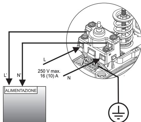
COLLEGAMENTO IN SERIE CON SICUREZZE CALDAIA:
